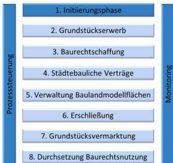
Abbildung 62 Prozess und Arbeitsschritte der Baulandentwicklung im Rahmen eines Baulandmodells als städtebauliche Gesamtmaßnahme (Grafik: T. Kötter 2023)
